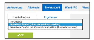
Mit der Wahl des Konstruktionstyps - im Folgenden beispielsweise "Holzdecke" - wird einerseits das Rechenverfahren und anderseits dann unter dem Button "Auswahl" die weitere Datenbankauswahl bestimmt.
