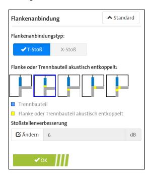
Mit Betätigung des OK Buttons werden die Konstruktionswerte des Flankenbauteils und bei massiven Bauteilen die Art der Stoßstelle übernommen und es wird die nächste Registerseite "Decke (F2)" aufgerufen.
