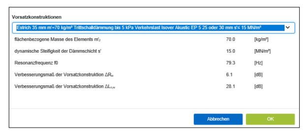
Die Auswahl für die Unterdecke verläuft analog. Auch hier wird die Verbesserung des Luftschallschutzes sofort angezeigt.
