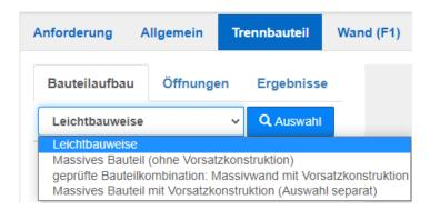
Mit der Wahl des Konstruktionstyps - im Folgenden beispielsweise "Leichtbauweise" - wird einerseits das Rechenverfahren und anderseits dann die unter dem Button "Auswahl" die weitere Datenbankauswahl bestimmt.
