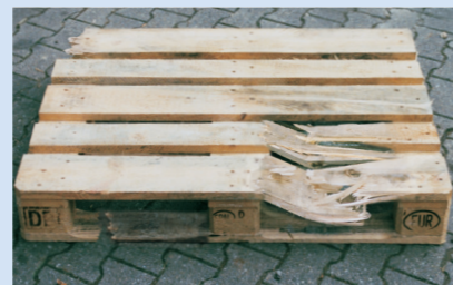
Mehr als 3 Bauteile defekt
