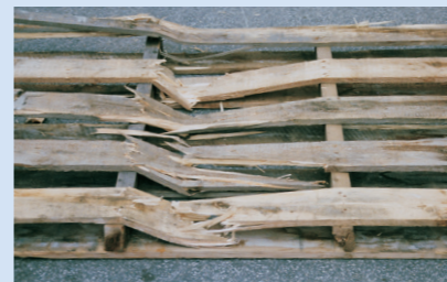
Mehr als 3 Bretter defekt
